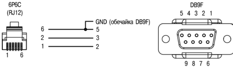
Рисунок В.2 – Схема кабеля KC2
