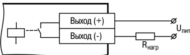
Рисунок Б.10 – Схема подключения нагрузки к ВЭ типа «Р»
